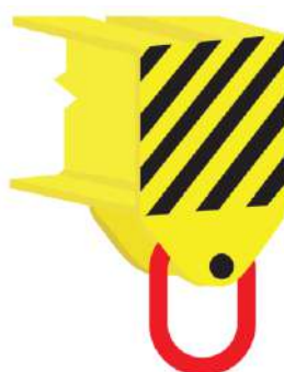
Захват, встроенный в траверсу (T10)
