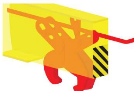
Захват, встроенный в траверсу (T10)
