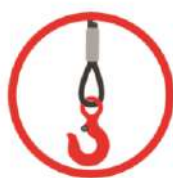
работа при отсутствии защелки на крюках
