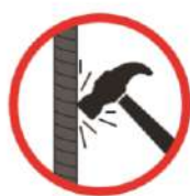
удары по элементам стропа
